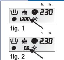
В стиральной машине предусмотрен широкий выбор скоростей отжима, которые устанавливаются в соответствии с выбранной программой перед ее пуском. Для изменения скорости отжима достаточно просто нажать кнопку (H) до достижения требуемого значения (рис. 1); при желании исключить отжим нажмите кнопку, пока на дисплее остается символ отжима и надпись "00" (рис. 2).
