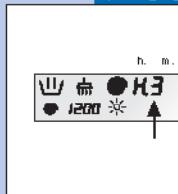
Машина располагает функцией, позволяющей отложить процесс стирки максимум на 16 часов. При каждом нажатии кнопки (L) на дисплее появляется час от 1 до 16, соответствующий времени ожидания начала цикла. После нажатия кнопки (L) стиральная машина ждет введенное в программу количество часов задержки, а затем автоматически начинает цикл стирки.
