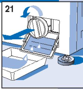
Чтобы собрать воду, оставшуюся в фильтре, положить под него тряпку или подставить плоскую миску. Открыть крышку фильтра, открутить его против часовой стрелки и вынуть (рис. 21).
