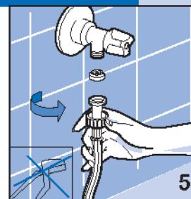
**Прим.** В электронных стиральных машинах, оборудованных двойным электроклапаном (горячей и холодной воды) соедините красную трубку скраном горячей воды, а другую трубку - с краном холода. Если кран горячей воды использовать нельзя, обе трубы должны быть подсоединенены к крану холода воды при помощи специального прилагаемого патрубка (смотри рис. 5A).
