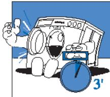
**После завершения стирки, чтобы открыть дверцу машины, необходимо подождать примерно три минуты, так как на замке установлено предохранительное устройство, защищающее от случайного открывания прибора.**
